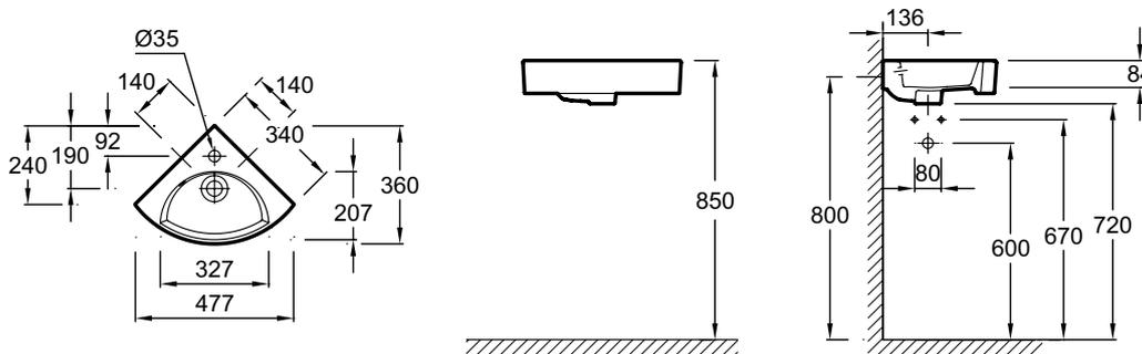
Descriptif CCTP : Lave-mains d'angle 34 cm. EGP112. Collection : ODÉON RIVE GAUCHE. DIMENSIONS : 34 x 34 cm. POIDS : 7,2 kg. MATÉRIAU : Céramique. TYPE D'INSTALLATION : Autoportant ou peut être monté sur un meuble spécifique. PERCEMENT ROBINETTERIE : 1 trou. CONFIGURATION : Angle. TROP-PLEIN : Avec trou de trop plein. ROBINETTERIE CONSEILLÉE : Odéon Rive Gauche. INFOS COMPLÉMENTAIRES : Robinetterie non incluse.
