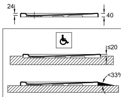
Descriptif CCTP : Receveur 90 x 90 cm - extraplat. ENC90. Collection : KYRÉO. DIMENSIONS : 90 x 90 x 4 cm. POIDS : 29 kg. MATÉRIAU : Céramique. TYPE D'INSTALLATION : Posé ou encastré. NORMES ET RÉGLEMENTATIONS : NF. ANTIDÉRAPANT : Non. FORME : Carré. DIAMÈTRE DE BONDE (CM) : 9. MOTIF DE SURFACE : Lisse. NIVEAU D'ADHÉRENCE : PN6. LIVRÉ AVEC BONDE : Non. DURÉE GARANTIE (ANNÉES) : 10.
