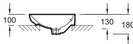
Descriptif CCTP : Vasque à poser 56 cm. EVI102. Collection : NOUVELLE VAGUE. DIMENSIONS : 56 x 40 cm. POIDS : 9 kg. MATÉRIAU : Céramique. TYPE D'INSTALLATION : Posé. TROP-PLEIN : Avec trou de trop-plein. ROBINETTERIE CONSEILLÉE : Nouvelle Vague.
