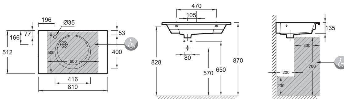
Descriptif CCTP : Plan-vasque céramique, 80 cm, non-meulé. EXAW112. Collection : ODÉON RIVE GAUCHE. DIMENSIONS : 81 x 51,20 cm. POIDS : 23,2 kg. MATÉRIAU : Céramique. TYPE D'INSTALLATION : Autoportant. PERCEMENT ROBINETTERIE : Percé 1 trou. CONFIGURATION : STANDARD. MEULÉ/NON-MEULÉ : Non meulé. TROP-PLEIN : Avec trou de trop-plein. NOMBRE DE VASQUES : Simple vasque. ROBINETTERIE CONSEILLÉE : Odéon Rive Gauche (plusieurs choix de finitions). INFOS COMPLÉMENTAIRES : robinetterie non incluse.
