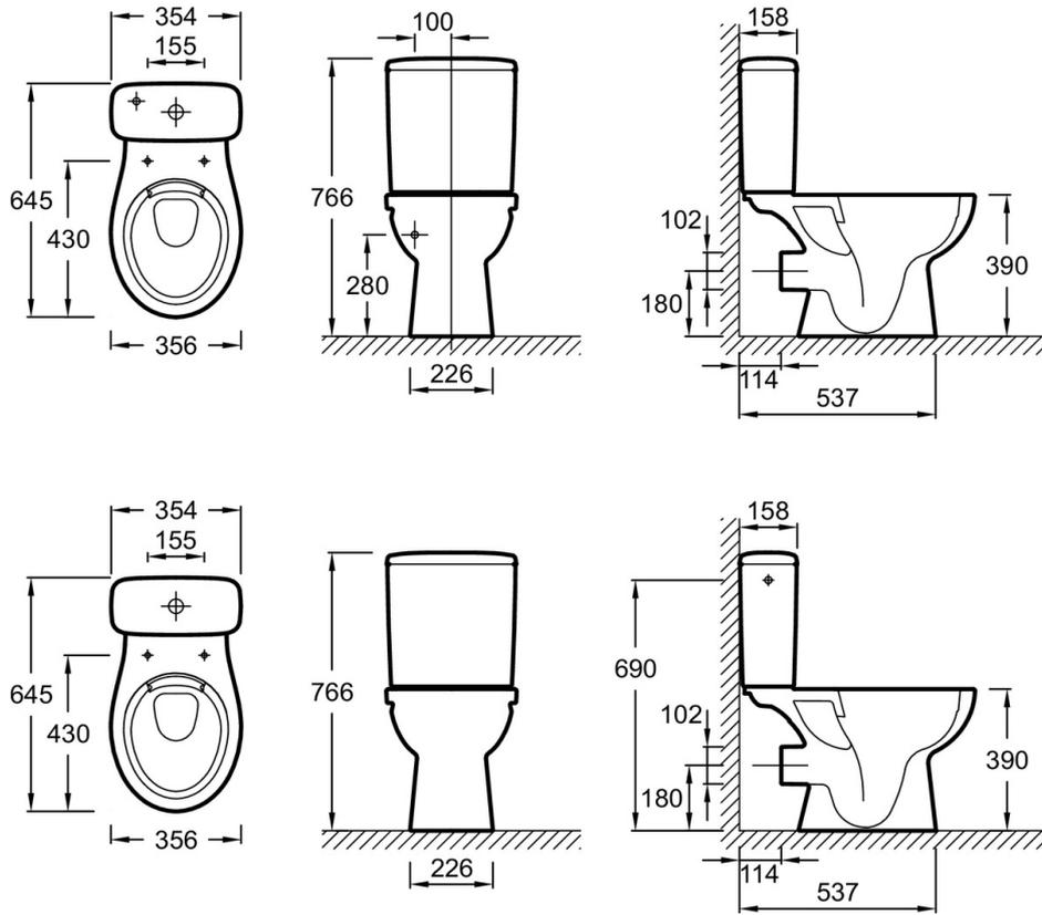
Descriptif CCTP : Cuvette au sol SANS BRIDE, sortie horizontale. UJV101. Collection : PATIO. DIMENSIONS : 64,40 x 35,60 cm. POIDS : 22,1 kg. MATÉRIAU : Céramique. TYPED'INSTALLATION : Au sol. NORMES ET RÉGLEMENTATIONS : NF. ÉVACUATION : Sortie horizontale. FORME : Arrondie. MÉCANISME DE CHASSE : Double chasse. CONSOMMATION D'EAU : 2,6/4 L et 3/6 L. HAUTEUR : Standard. TYPE DE BRIDE : Sans bride. GARANTIE DE LA CÉRAMIQUE : 10 ans. FIXATION DE LA CUVETTE : Non fournie.
