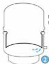
Enclenchement pompe. L'eau entre dans le réservoir.
