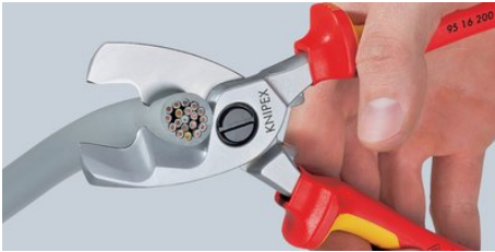
Coupe définitive : une fois la gaine du câble coupée dans le profil avant, on coupe les conducteurs dans le profil arrière. Coupe préliminaire à l'avant, coupe définitive à l'arrière – la coupe est plus facile.
