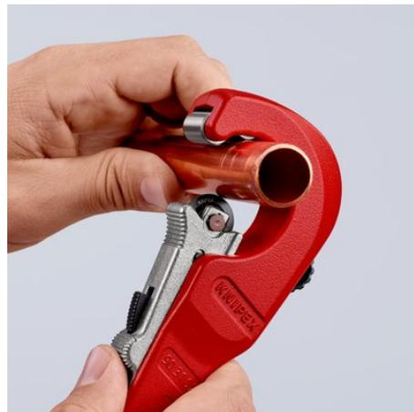
Poussez la molette de coupe contre le tube avec le système QuickLock à verrouillage en butée rapide d'une seule main : le réglage le plus rapide pour différents diamètres de tubes
