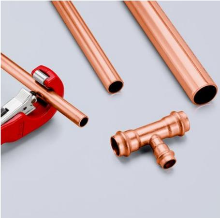
Pour couper des tubes en cuivre, laiton, acier inoxydable et des tubes rigides en acier d'une épaisseur de paroi jusqu'à 2 mm et d'un diamètre de 6-35 mm (1/4"-1 3/8")
