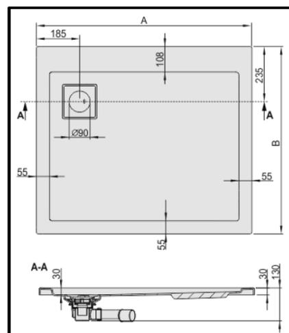
**\* NOTA BENE : Pour les receveurs SPACE LINE 75x90, 80x90, 80 x 100 et 90x100 la bonde est dans l'angle GAUCHE et non au Centre**
