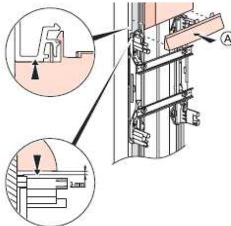
Mise en place du couvercle dans les cornets et clipsage.
