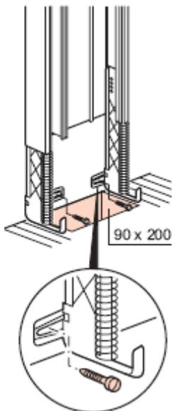
Fixation de la goulotte pré-percée au mur et fixation des pieds compensateurs au mur à l'endroit indiqué
