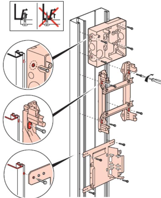
Pour la fixation de coffrets, utiliser les pastilles de fixation livrées avec les kits GTL :
