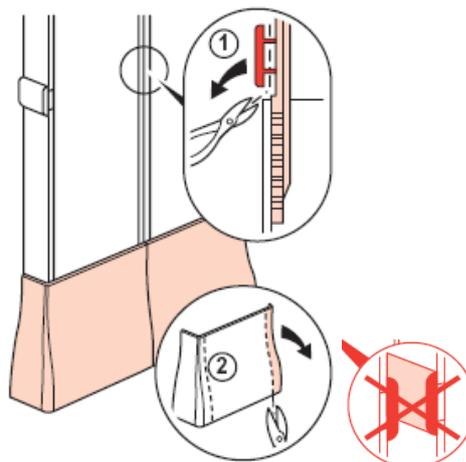
La juxtaposition de deux Kits GTL nécessite la découpe des caches de finition suivant le repérage à l'intérieur
