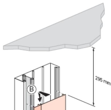
Il faut laisser 295mm entre le bord du couvercle et le plafond pour permettre le clipsage du cornet d'épanouissement.
