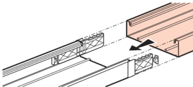
S'assurer de la bonne mise en place des éclisses (elles sont pré-montées à l'intérieur du corps, il faut insérer l'autre partie de la goulotte jusqu'à la butée)
