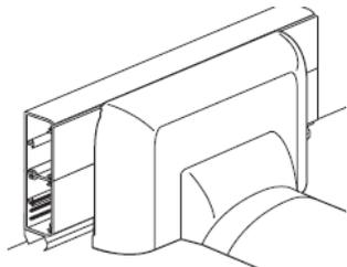
Permet la dérivation d'une goutte DLP vers un passage de plancher réf. 032800.
