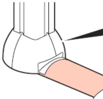
Il est possible de raccorder une colonnette vers un passage de plancher réf. 032800.
