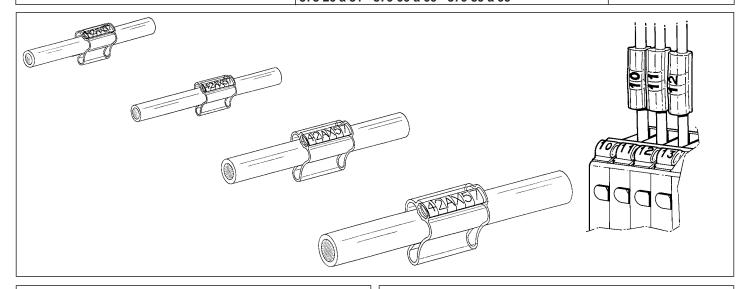
Le système de repérage à bague fermée pour filerie et blocs de jonction
