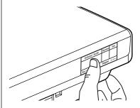
Cette étiquette de maintenance (réf. 609 00) doit être apposée de manière visible sur chaque bloc autonome d'éclairage de sécurité en y inscrivant la date de mise en service du bloc.
