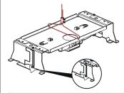
Important: Les blocs doivent être fixés sur un élément porteur du plafond de sorte qu'ils ne risquent pas de tomber ou se décrocher pendant le début d'un sinistre ou dès qu'il y a accident (les plaques qui se désagrègent à l'eau ne sont pas de supports fiables pour les BAES).
