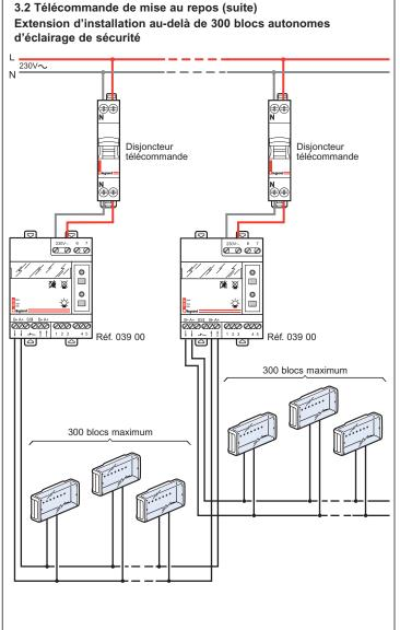
Mise au repos par zone d'une installation comportant plusieurs zones d'exploitation
