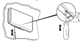
Déverrouillage possible par tournevis de longueur minimum 15 cm
