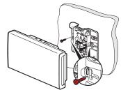
2 Fixation avec 2 vis supplémentaires dans le mur
