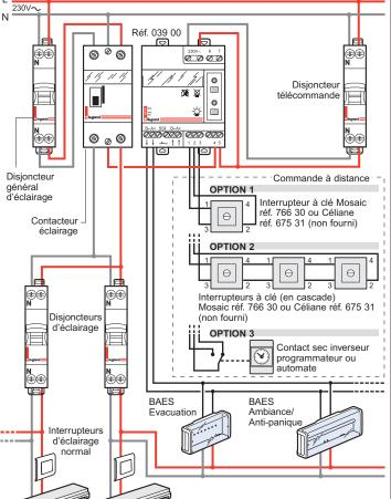
Mise au repos automatique des blocs après la coupure volontaire de l'éclairage
