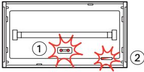
Allumage du témoin de veille à LEDs ①, LED verte allumée ② (clignotante pendant la charge des accumulateurs 28 h max.).
