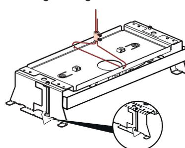
**Important :** Les blocs doivent être fixés sur un élément porteur du plafond de sorte qu'ils ne risquent pas de tomber ou se décrocher pendant le début d'un sinistre ou dès qu'il y a accident (les plaques qui se désagrègent à l'eau ne sont pas de supports fiables pour les BAES).
