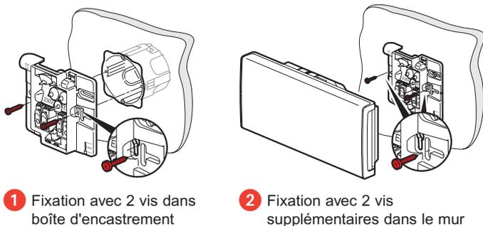
① Fixation avec 2 vis dans boîte d'encastement
