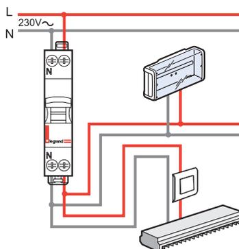
La dérivation peut se faire dans l'armoire électrique, sur l'interrupteur ou dans une boîte de dérivation. L'alimentation des blocs est soumise aux mêmes règles que les luminaires (câblage normal).
