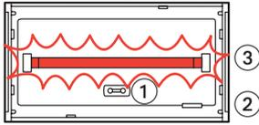
Extinction du témoin de veille à LEDs ① et de la LED verte ②. Allumage du tube 8 W de sécurité ③.
