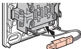
\* Une borne pour le raccordement du neutre est prévue sur réf. 860 17 et 861 17
