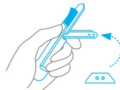
À l'aide de l'index, **déployer lentement vers le bas** le support de lame, de l'autre main, retirer et retourner (pour gauchers) ou changer la lame.
