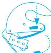
Appuyer sur la languette et, **simultanément**, extraire le pied métallique de la poignée. Retourner ou changer la lame.
