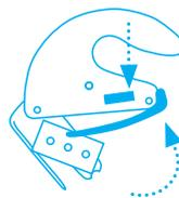
Abaisser à nouveau la languette en repoussant le pied métallique dans le manche jusqu'à ce qu'il **s'enclenche**. Vérifier la bonne mise en place.
