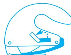
Replacer la languette dans sa **position initiale**.
