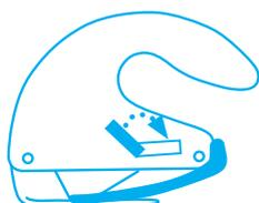
**Relever** et tourner la languette vers le bas jusqu'à ce que son extrémité entre en contact avec le bouton de changement de lame.
