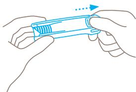
Appuyez sur le bouton de changement de lame et tirez l'**insert en plastique vers l'arrière**.
