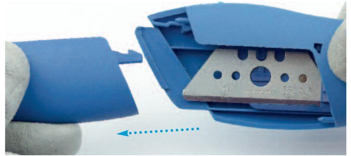
**03/**Sortir la lame au maximum en actionnant la gachette. Sortir délicatement la lame par l'avant.
