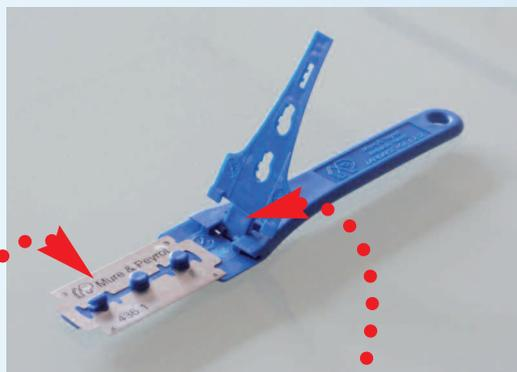
Trappe permettant de changer la lame
