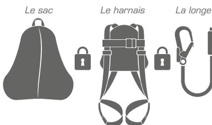
La gamme KTP EVO développée par PMS Industrie propose plusieurs modèles de systèmes antichute et de retenue indémontables : le sac, le harnais et la longe sont indissociables. Chaque modèle est utilisable instantanément, et équipé d'une longe différente pour s'adapter à tous types d'utilisations.
