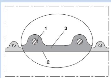
Tuyau flexible d'aspiration et de refoulement, résistant à l'abrasion et antistatique
