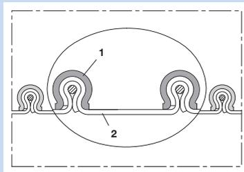
Tuyau flexible d'aspiration et de ventilation; PVC, ultraléger + compressible, Ø jusqu'à 1.000 mm (jusqu'à 110°C)
