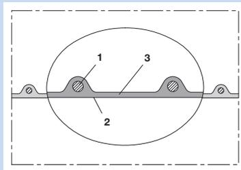
Tuyau flexible d'aspiration et de refoulement, résistant à l'abrasion et antistatique; PUR <math>10^9 \Omega</math>, léger, lisse à l'intérieur
