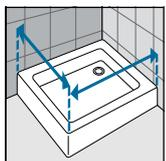
Prendre les mesures (cm) du mur au bord extérieur du receveur de douche. Relever les mesures (cm) après la pose du carrelage. Pour les montages en angle, il faut prévoir que la mesure réelle correspond à la mesure d'encombrement extérieur avec le profilé mural de la paroi en retour. Ceci doit être pris en compte impérativement pour les receveurs carrelés (pose à l'italienne ou receveur sans plage).
