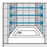
Prendre les mesures (cm) d'un mur à l'autre, en bas, en haut et au milieu et choisir la mesure inférieure.
