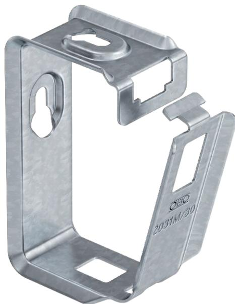
Passes-câbles métalliques pour une résistance mécanique élevée, même en cas d'incendie. Apprôprié pour un montage sécurisé au-dessus de plafonds coupe-feu. Autorisé également comme variante spécifique pour la sécurité de fonctionnement électrique selon la norme DIN 4102 partie 12. Pour montage au mur et au plafond. Fermeture ouvrable sans outil. Se reporter aux documents de test correspondants pour de plus amples détails sur les variantes de pose.
