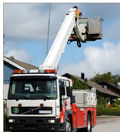
Version 518D conforme aux normes électriques non conducteur SAEJ517 et ISO 3949
