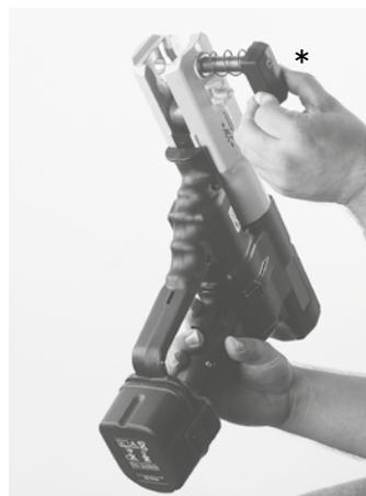
Ouvrir l'axe de retenue à l'avant de la machine en poussant sur le bouton \*
