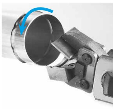
Ouvrir à nouveau les 2 mâchoires afin de ressortir le tube. Positionner l'extrémité de la pince près du repère de bossage : ceci permet d'éviter le chevauchement des bossages. Tourner légèrement le tube.
