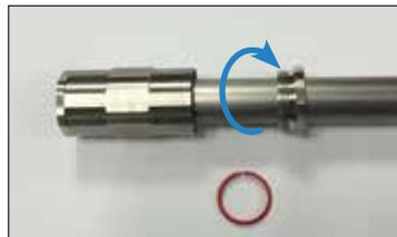
Démontage : 1. Démontez manuellement l'écrou et le faire glisser le long du tube.
