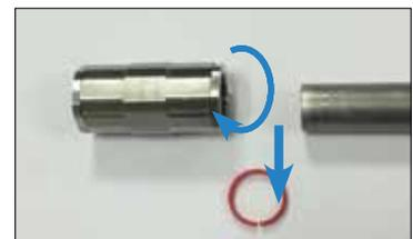
Démontage : 5. Revisser l'écrou sur le raccord sans la bague rouge. Le raccord est prêt à être ré-assemblé.
