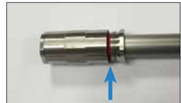
Démontage : 2. Mettre la bague de démontage rouge sur le tube et revisser l'écrou sur le raccord.
