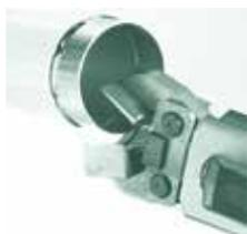
Ouvrir manuellement les 2 mâchoires de la pince. Insérer le tube dans la pince jusqu'en butée.
