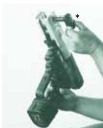
Ouvrir l'axe de retenue à l'avant de la machine en poussant sur le bouton \*
