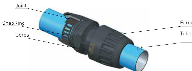
Les raccords de jonction Ø 50 et Ø 63 se connectent au tube Transair® aluminium au moyen d'un SnapRing. Celui-ci rend le raccord et le tube
