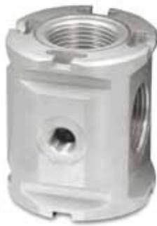
Les blocs collecteurs fournissent 4 orifices de sortie supplémentaires, Ils peuvent être placés n'importe où dans la configuration, par exemple avant le lubrificateur pour des sorties en air non lubrifié, ou encore à la fin pour fournir des orifices de sortie supplémentaires.
