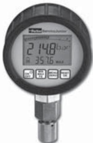
Le ServiceJunior réunit les fonctions mesure et affichage des pressions en un même appareil. L'affichage sur quatre chiffres donne les mesures avec une grande précision. Les pointes de pression sont assurément acquises à la vitesse d'échantillonnage de 10 ms.
