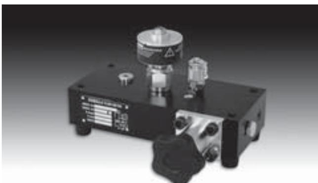
Ces testeurs hydrauliques permettent de mesurer précisément le débit, la pression et la température. Les testeurs peuvent également être utiles pour entretenir des circuits hydrauliques, localiser des sources d'erreur sur des soupapes de commande directionnelle et régler des soupapes. La soupape de charge, avec ses disques cassants de dérivation intégrés, permet d'augmenter progressivement la pression pour contrôler le débit dans la totalité d'une zone de travail.
