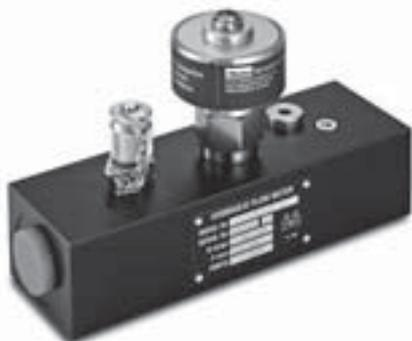
Une roue de turbine est entraînée par l'écoulement de l'huile. Les fréquences ainsi obtenues sont traitées par l'électronique numérique. L'incidence des effets de l'écoulement turbulent est compensée. En raison de la faible résistance à l'écoulement QR, le circuit hydraulique fonctionne avec des très faibles.
