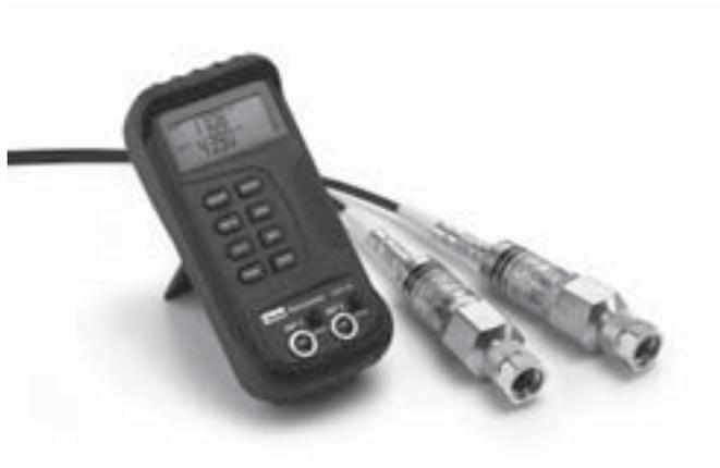
L'appareil Serviceman possède deux entrées pour capteurs. La fonction de pression différentielle s'obtient par simple sélection de sa touche. La comparaison entre les consignes et valeurs réelles se réalise simplement.
