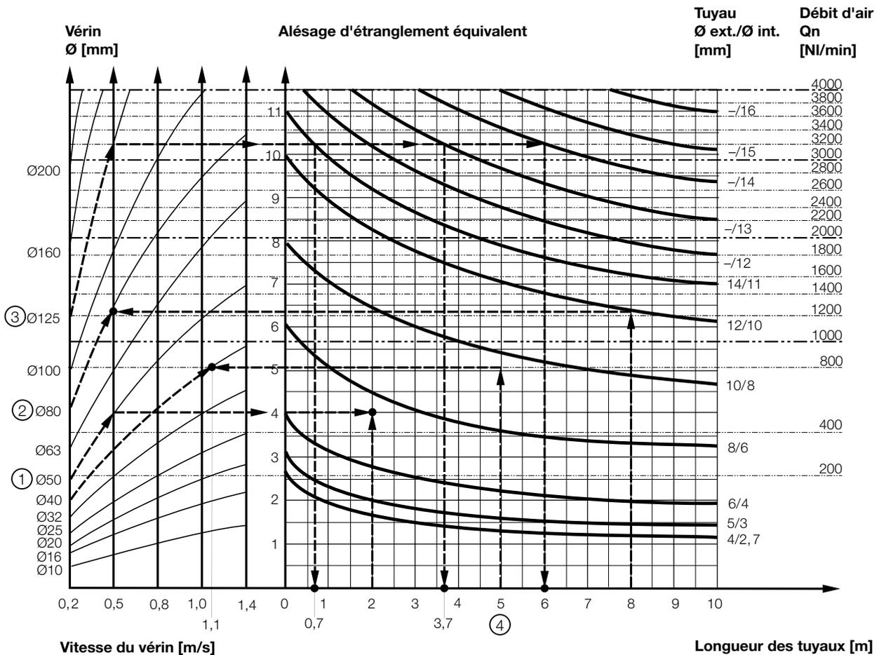
L'« alésage d'étranglement équivalent » est un long étranglement (un tuyau, par exemple) ou une série d'étranglements remplacé par un étranglement court pour obtenir le même débit. Ne pas confondre avec l'« orifice », parfois indiqué pour les distributeurs. La valeur de l'orifice ne prend généralement pas en compte le fait qu'un distributeur inclut plusieurs étranglements.
