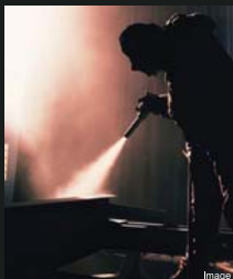
■ IP69K (Test au jet de vapeur à 80°C)
