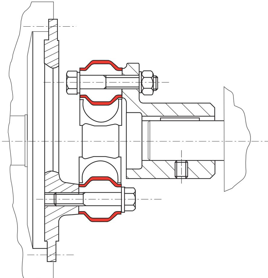
**Exemple : liaison moteur thermique/groupe électrogène
