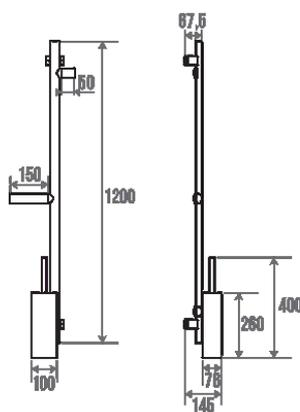
Tube elliptique 38x25 mm en aluminium, cache-fixations en polymère.
