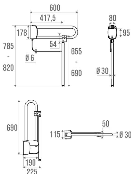
Tube aluminium blanc Ø 30 mm. Platines en résine de synthèse.
