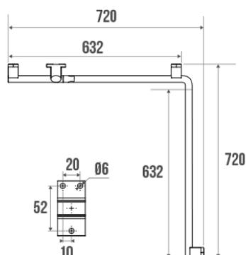
Tube elliptique 38x25 mm en aluminium époxy gris anthracite. Angle 90°. Symétrique. Cache-fixations en résine de synthèse gris anthracite. 3 points de fixations invisibles. Le 3ème point est à positionner pour version droite ou gauche. Garantie anticorrosion.
