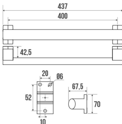
Tube elliptique 38 x 25 mm en aluminium époxy blanc. Cache-fixations en résine de synthèse blancs.
