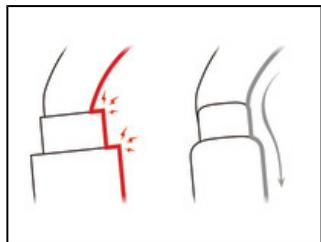
Le design intérieur fluide des mousquetons Am'D limite le risque de point stable et facilite la rotation du mousqueton.
