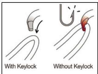
Pour garantir une efficacité optimale lors des manœuvres, les mousquetons OXAN utilisent le système Keylock : l'interface, composée du corps et du doigt, est dépourvue de crochet, afin d'éviter l'accrochage involontaire du mousqueton sur l'ancrage, la corde, le porte-matériel du harnais...
