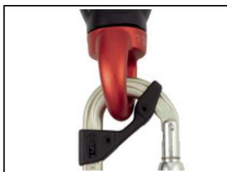
La forme, ovale et symétrique, permet de positionner le mousqueton de façon optimale. La barrette de maintien CAPTIV favorise la sollicitation du mousqueton selon le grand axe, limite le risque de retournement et le solidarise à l'appareil.
