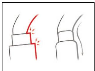
Le design intérieur fluide des mousquetons OXAN limite le risque de point stable et facilite la rotation du mousqueton.
