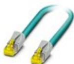
Câble patch, CAT6<sub>A</sub>, 4 paires, blindé, liaison non croisée (Line), équipé des deux côtés avec connecteurs RJ45/IP20, matériau gaine extérieure : PUR, longueur : 2,0 m
