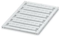
Repères pour blocs de jonction, à commander : sous forme de planche, blanc, impression selon les indications du client, type de montage: encliquetage dans la rainure de repérage plate, pour bloc de jonction au pas de : 8,2 mm, surface utile: 7,4 x 4,7 mm, Nombre d'étiquettes: 42
