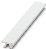
Ruban de repérage ZB, Rubans, blanc, vierge, repérable avec : PLOTMARK, CMS-P1-PLOTTER, type de montage: encliquetage, pour bloc de jonction au pas de : 8,2 mm, surface utile: 10,5 x 8,15 mm, Nombre d'étiquettes: 10
