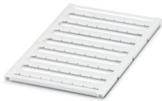
Repères pour blocs de jonction, à commander : sous forme de planche, blanc, impression selon les indications du client, type de montage: encliquetage dans la rainure de repérage plate, pour bloc de jonction au pas de : 8,2 mm, surface utile: 7,6 x 5,1 mm, Nombre d'étiquettes: 56
