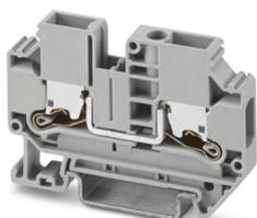
Blocs de jonction simple, tension nominale: 1000 V, intensité nominale: 41 A, nombre de connexions: 2, nombre de pôles: 1, type de raccordement: Raccordement Push-X, Section de référence: 6 mm<sup>2</sup>, section : 0,5 mm<sup>2</sup> - 10 mm<sup>2</sup>, type de montage: NS 35/7,5, NS 35/15, coloris: gris
