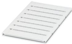
Repères pour blocs de jonction, à commander : sous forme de planche, blanc, impression selon les indications du client, type de montage: encliquetage dans la rainure de repérage élevée, pour bloc de jonction au pas de : 8,2 mm, surface utile: 7,6 x 10,5 mm, Nombre d'étiquettes: 56
