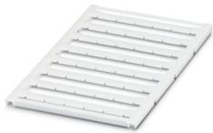
Repères pour blocs de jonction, à commander : sous forme de planche, blanc, impression selon les indications du client, type de montage: encliquetage dans la rainure de repérage plate, pour bloc de jonction au pas de : 12 mm, surface utile: 11,45 x 5,1 mm, Nombre d'étiquettes: 40
