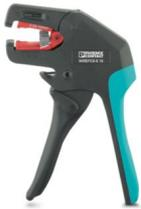
Outil à dénuder, pour câbles et conducteurs de 4 - 16 mm<sup>2</sup>, réglage automatique, longueur à dénuder jusqu'à 18 mm, capacité de sectionnement jusqu'à 10 mm<sup>2</sup> flexible/ 1,5 mm<sup>2</sup> rigide, couteau de dénudage remplaçable
