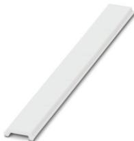
Ruban de repérage ZB, plat, Rubans, blanc, vierge, repérable avec : PLOTMARK, CMS-P1-PLOTTER, type de montage: encliquetage, pour bloc de jonction au pas de : 12 mm, surface utile: 5,15 x 12,15 mm, Nombre d'étiquettes: 5
