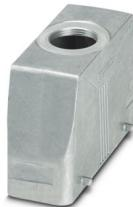
Capot passe-câble B24, pour étrier transversal, matériau: Aluminium coulé sous pression, résistant à l'eau de mer, nombre de sorties: 1, droit, 1x M32, hauteur: 76 mm, presse-étoupe: sans, Standard
