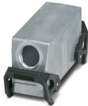
Capot passe-câble B24, avec étrier transversal, matériau: Aluminium coulé sous pression, résistant à l'eau de mer, nombre de sorties: 1, latérale, 1x Pg16, hauteur: 60 mm, presse-étoupe: sans, Standard
