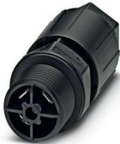
Traversée de paroi, product family: QPD, type de raccordement: Raccordement par clips/ Raccordement IDC, nombre de pôles: 2+PE, M20, Mâle, 690 V, 15 A, PA, noir, avec écrou QUICKON, diamètre extérieur du câble: 5 mm ... 9,5 mm (pour clips selon DIN 46247-2), 1,5 mm<sup>2</sup>
