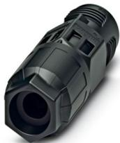
Prolongateur de câble, product family: QPD, type de raccordement: Raccordement IDC, nombre de pôles: 2+PE, 690 V, 17,5 A, PA, noir, avec un écrou QUICKON, diamètre extérieur du câble: 5 mm ... 9,5 mm
