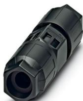
Prolongateur de câble, product family: QPD, type de raccordement: Raccordement IDC, nombre de pôles: 2+PE, 690 V, 17,5 A, PA, noir, avec deux écrous QUICKON, diamètre extérieur du câble: 5 mm ... 9,5 mm
