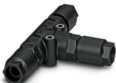
Répartiteur en T, product family: QPD, type de raccordement: Raccordement IDC, nombre de pôles: 2+PE, 690 V, 17,5 A, PA, noir, avec 3 écrous QUICKON, diamètre extérieur du câble: 5 mm ... 9,5 mm
