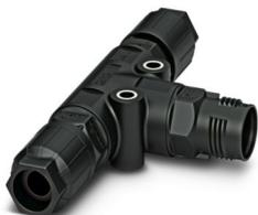
Répartiteur en T, product family: QPD, type de raccordement: Raccordement IDC, nombre de pôles: 2+PE, 690 V, 17,5 A, PA, noir, avec deux écrous QUICKON, diamètre extérieur du câble: 5 mm ... 9,5 mm
