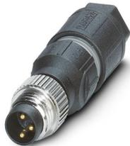
Connecteur, Universel, 3-pôles, connecteur mâle droit M8, codage: A, Raccordement autodénudant, matériau de la molette: Zinc moulé sous pression, nickelé, diamètre extérieur du câble 2,5 mm ... 5 mm
