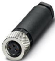
Connecteur, 3-pôles, Connecteur femelle droite M8, détrompage A, Raccordement vissé, Matériau de la molette: laiton, nickelé, Diamètre extérieur du câble 3,5 mm ... 5 mm
