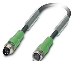
Câble pour capteurs/actionneurs, 4-pôles exempt d'halogène, connecteur mâle droit M8, détrompage: A, sur Connecteur femelle droit M8, longueur de câble: 1,5 m
