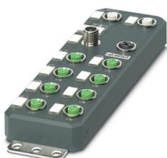
Axioline E, Périphérique d'entrée / de sortie numérique, EtherNet/IP™, Connecteur M12, Entrées TOR: 16, 24 V DC, connectique: 4 fils, Sorties TOR: 16, 24 V DC, connectique: 3 fils, Capot en plastique, indice de protection: IP65/IP67
